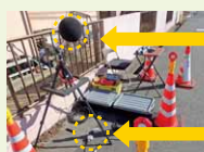
騒音測定マイク 振動測定用機器
